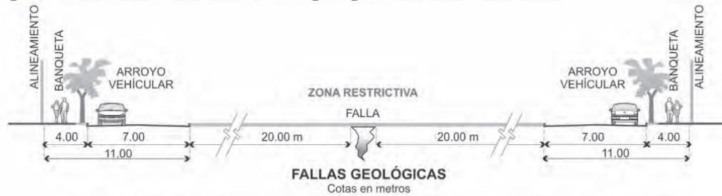
Figura No. 103. Área de restricción en fallas geológicas.
