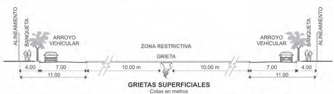
Figura No. 104. Área de restricción en grietas superficiales.
